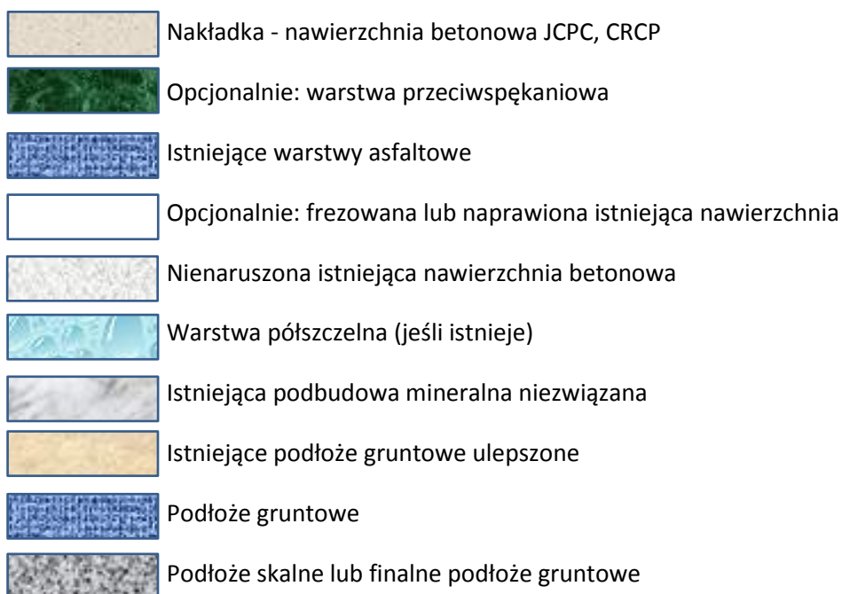
Rys. 3-4b. Nakładki betonowe na nawierzchniach podatnych, półsztywnych lub betonowych – strategię projektowania symulowane w MEPDG (patrz: podrozdział 13.3) (grubość warstw nie w skali rzeczywistej)
